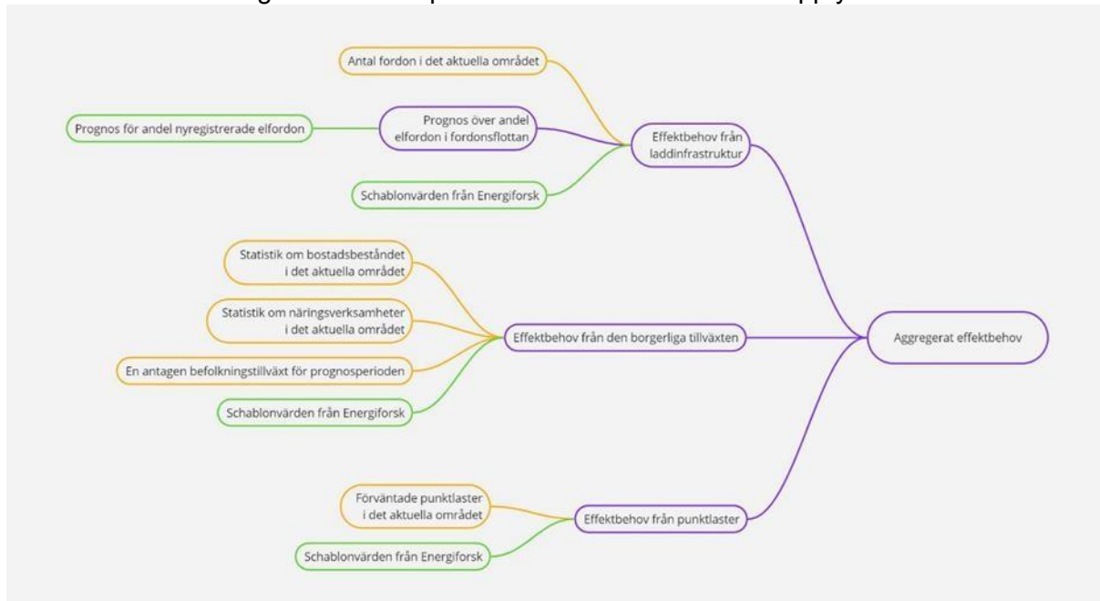
Figur 2 - visar schema över hur prognosverktyget är uppbyggt. Gröna boxar är sådana som tillhandahållits av Energiforsk, orangea boxar är sådana användaren behöver fylla i själv och lila boxar är resultat som bygger verktygets beräkningar.
